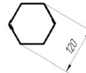
а) Сечение стойки в виде шестигранника СКИП-1
