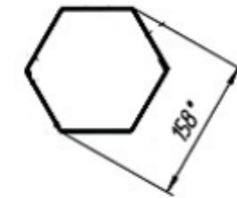
б) Сечение стойки в виде шестигранника СКИП-2
